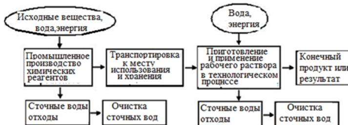
Рис. 13. Схема традиционной технологии с использованием покупных химических реагентов
