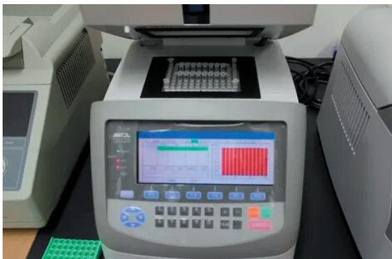
Рис. 2. Амплификатор для постановки ПЦР
