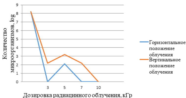
Рис. 1. Зависимость количества жизнеспособных микроорганизмов « Escherichia coli » от поглощённой дозы облучения в кГр для горизонтально и вертикально расположенных ампул
