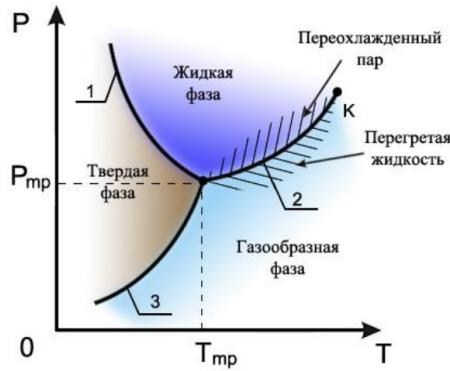
Рис. 1. Диаграмма метастабильных состояний при фазовом переходе жидкость-газ; 1 – кривая плавления; 2 – кривая испарения; 3 – кривая возгонки; К – критическая точка ( $T_k = 647,35^\circ\text{K}$ ,  $P_k = 218,5$  атм.) Источник: <https://thepresentation.ru/fizika/kondensirovannoe-sostoyanie-veshchestva-4>
