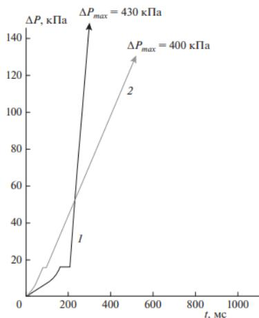
Рис. 4. Особенности влияния трифторметана на горение смеси 8 об. % пропан–воздух:
