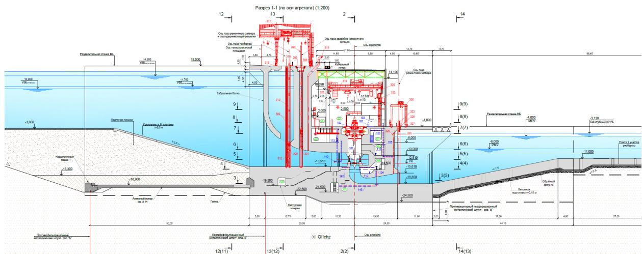
Рис. 1. Разрез по зданию МГЭС. Источник: коллектив АО «Институт Гидропроект», ПАО «Русгидро» в редакции авторов
