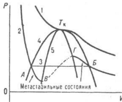
Рис. 3. Зависимости Р-В при  $T_k$  (1) и меньше  $T_k$  (2): ВГ – лабильные состояния (состояния неустойчивости не только к сильным, но и к слабым возмущениям); прямая 3 соединяет равновесные состояния жидкости и пара; 4 – бинодаль; 5 – спинодаль;  $T_k$  – критическая точка. Источник: <https://химик.ру/encyklopedia/1562.html>
