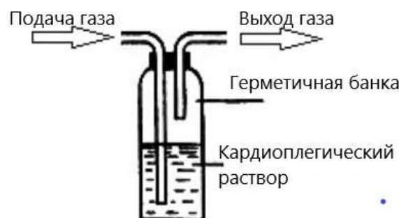
Рис. 3. Система увлажнения газовой смеси
