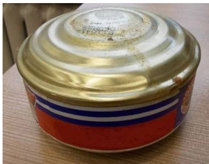
Рис. 5. Бомбаж консервированной продукции
