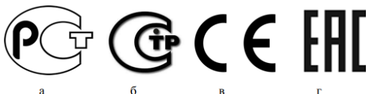
Рис. 5. Знаки соответствия: а – национальным стандартам России; б – техническим регламентам России; в – директивам ЕС; г – техническим регламентам таможенного союза
