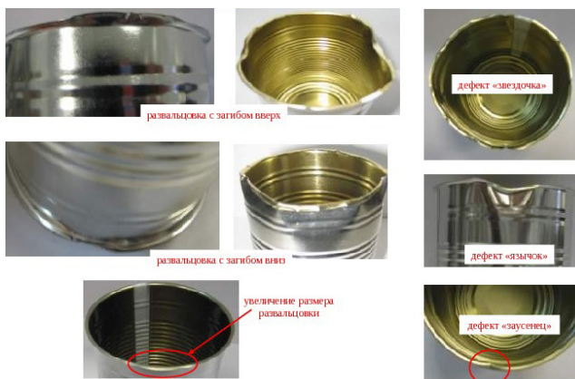
Рис. 34. Осмотр внутренней поверхности банок на наличие дефектов
