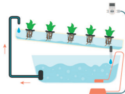
Рис. 29. Схема работы системы питательного слоя (NFT)
