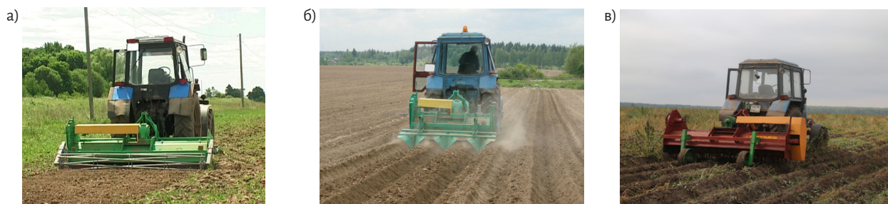
Рис. 1. Универсальная машина для возделывания картофеля: а) фреза; б) гребнеобразователь; в) ботводробитель
