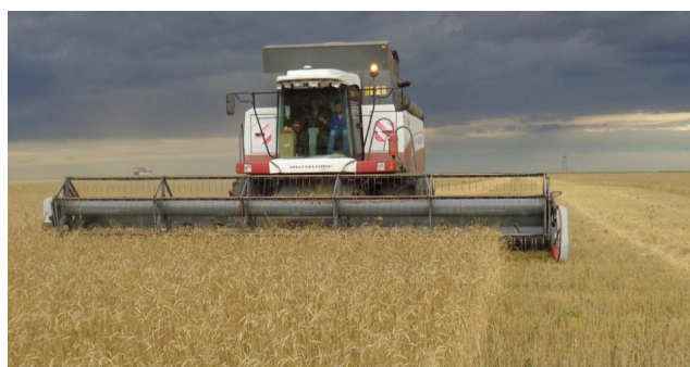
Рис. 2. Комбайн зерноуборочный РСМ-142 «ACROS-530» с жаткой Power Stream 9, в работе (вид спереди)
