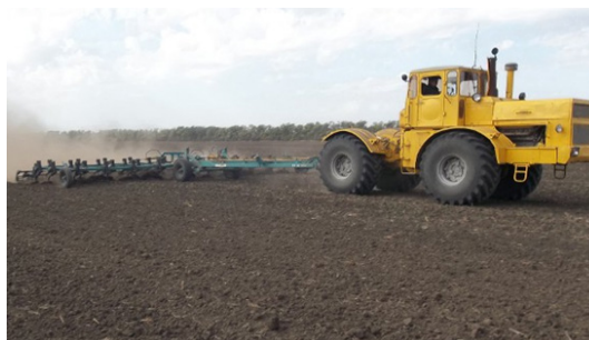
Рис. 4. Общий вид культиватора сплошной обработки почвы КСОП-12 в агрегате с трактором К-700А
