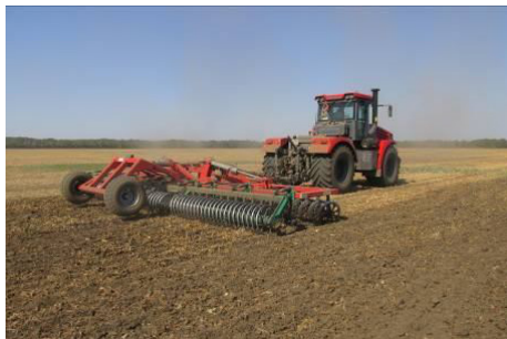
Рис. 1. Общий вид борны дисковой БДМ-9×2ПК в агрегате с трактором К-744РЗ
