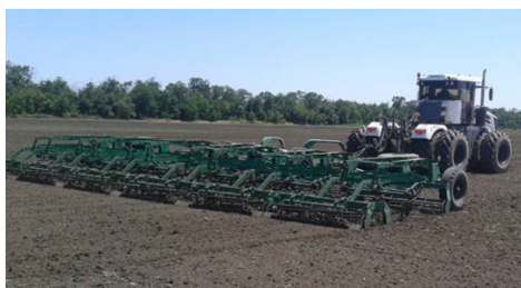
Рис. 5. Общий вид культиватора блочно-модульного прицепного КБП-12-4К1 в агрегате с трактором К-708.4
