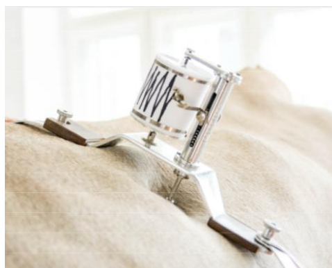
Рис. 2. Исследование моторики рубца при помощи руминографа
