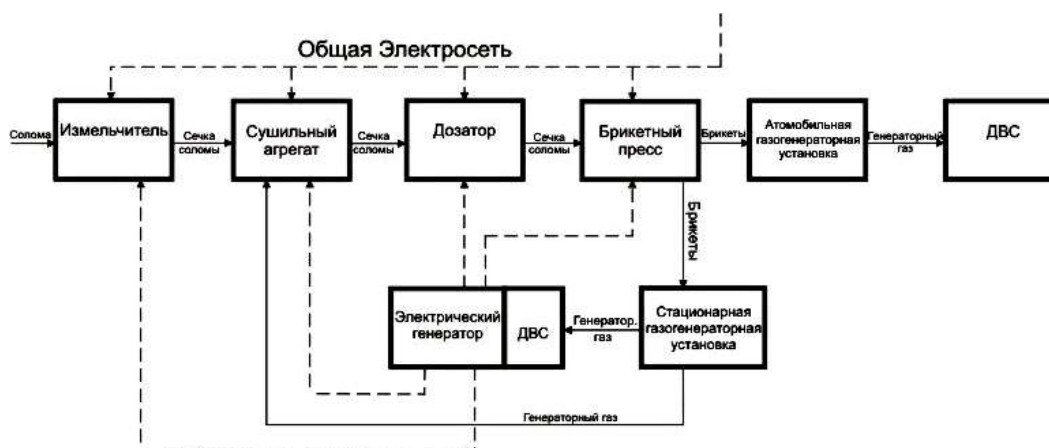
Рисунок 2. Технологическая схема производства генераторного газа из соломы [10]
