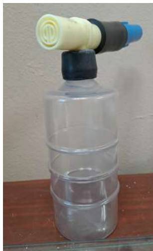
Рис. 59. Устройство для отбора средней пробы молока на автоматизированной доильной установке
