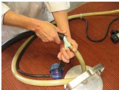
Рис. 71. Отсоединение магистрального вакуумного шланга
