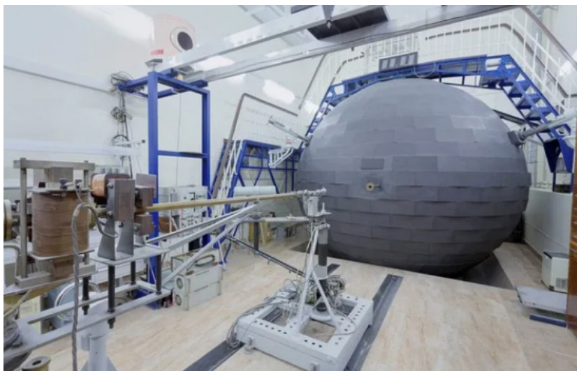
Рис. 5.2. Общий вид графитового замедлителя, входящего в состав государственного эталона единиц потока и плотности потока нейтронов
