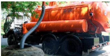
Рис. 54. Откачка сточных вод
