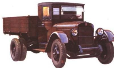
Рис. 4. АМО-2, собранный из узлов AutoCar-SA
